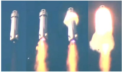
Blue Origin New Shepard 実験ミッションアボート →実験機器の喪失はせず (2022/9/12)
