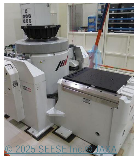
図1(左)：小型衛星振動試験設備 (JAXA筑波宇宙センター) (右)：小型衛星用スペースチャンバ (JAXA筑波宇宙センター)
