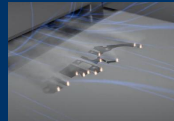
L-PBF造形技術 12本レーザーによる高速造形
