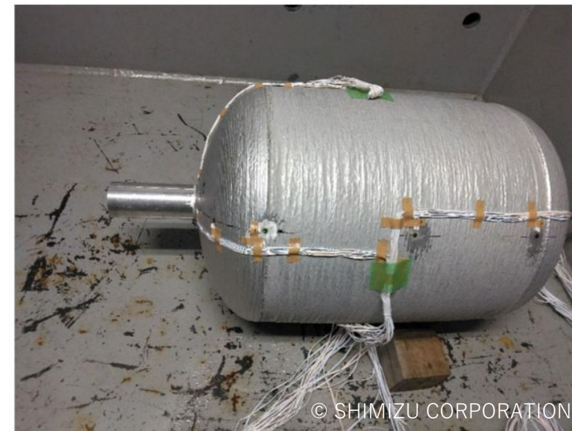
WAAM積層造形設備（左）とWAAM技術で造形した直径40cmの小型タンク（右）
