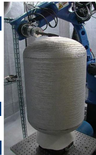
WAAM積層造形設備（左）とWAAM技術で造形した直径40cmの小型タンク（右）
