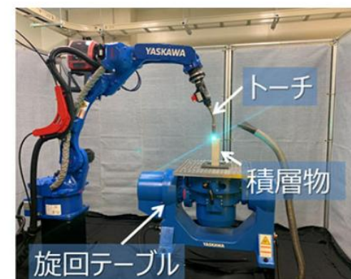
WAAMのしくみ（左）とロボットのアームにトーチを取り付けた装置（右）
